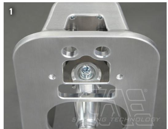
**i** Der Shifter ist für die Verwendung mit der originalen Mittelkonsole vorgesehen. Diese muss gemäß dieser Anleitung soweit ausgeschnitten werden, bis eine entsprechende Freigängigkeit gewährleistet ist.
