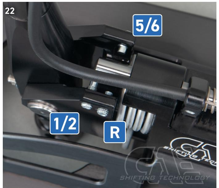
**BITTE BEACHTEN:** Bei den Gängen 1/2 und 5/6 darf die Madenschraube bei eingelegtem Gang den Sperrbolzen nicht berühren!
