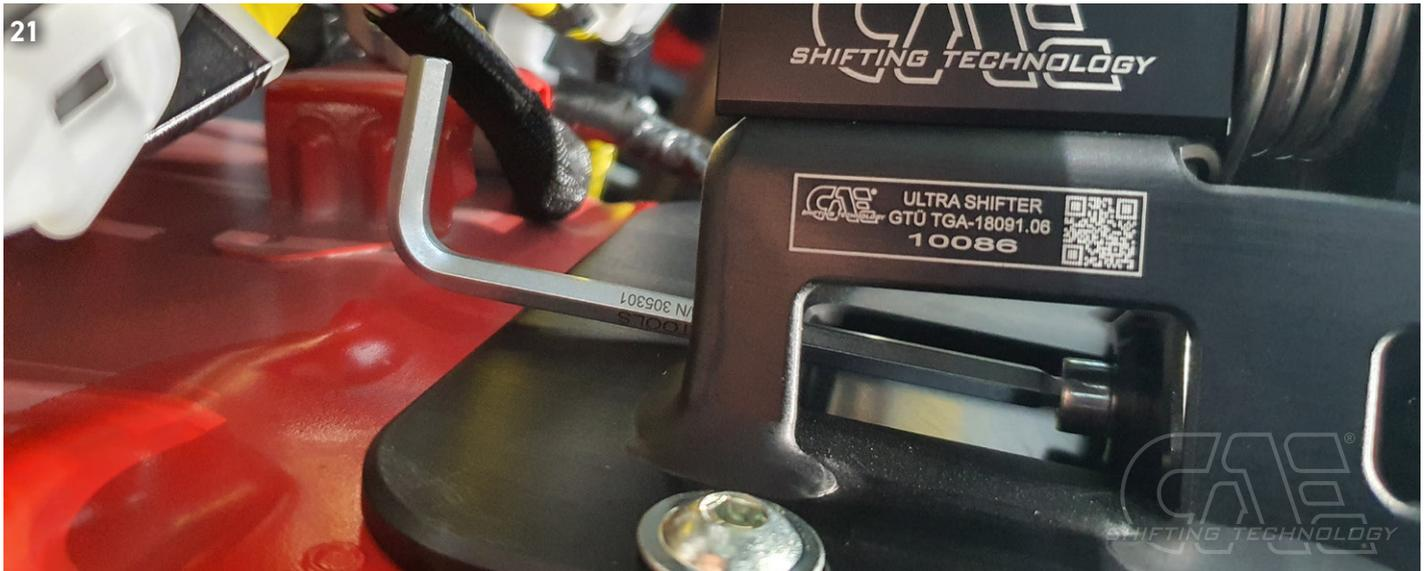
**PRÜFUNG:** Bei eingelegtem 3. und 4. Gang muss das seitliche Spiel am Schalthebel gleich groß sein. Sollte das nicht der Fall sein muss der Federanschlag nachjustiert werden. (0,5 mm sind hier schon eine Menge).
