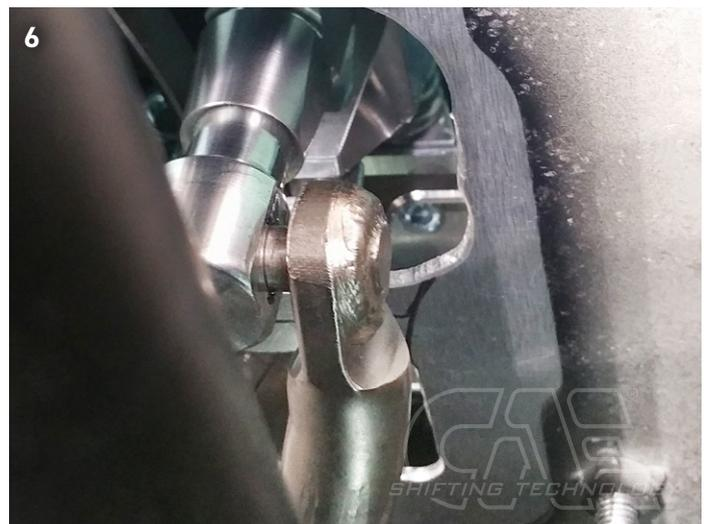
**PRÜFUNG:** Bei eingelegtem 3. und 4. Gang muss das seitliche Spiel am Schalthebel gleich groß sein. Sollte das nicht der Fall sein muss der Federanschlag nachjustiert werden. (0,5 mm sind hier schon eine Menge).
