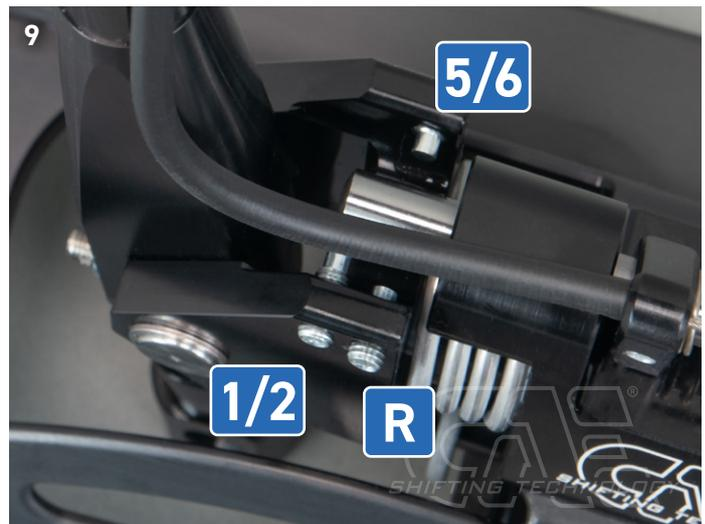
**! BITTE BEACHTEN:** Bei den Gängen 1/2 und 5/6 darf die Madenschraube bei eingelegtem Gang den Sperrbolzen nicht berühren!
