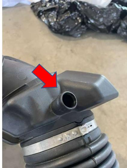
4. Als nächstes muss die Spange am Turboinlet entriegelt werden, damit das Turboinlet ausgebaut werden kann.
