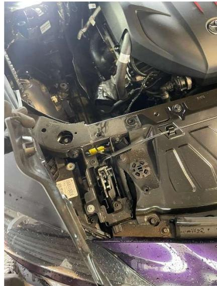
8. Nun kann das Abschrimblech eingesetzt werden. Vorne wird es mit der eben demontierten Schraube befestigt. Hinten wird es mit der mitgelieferten Schraube (mit Befestigungsgummi) verschraubt.
