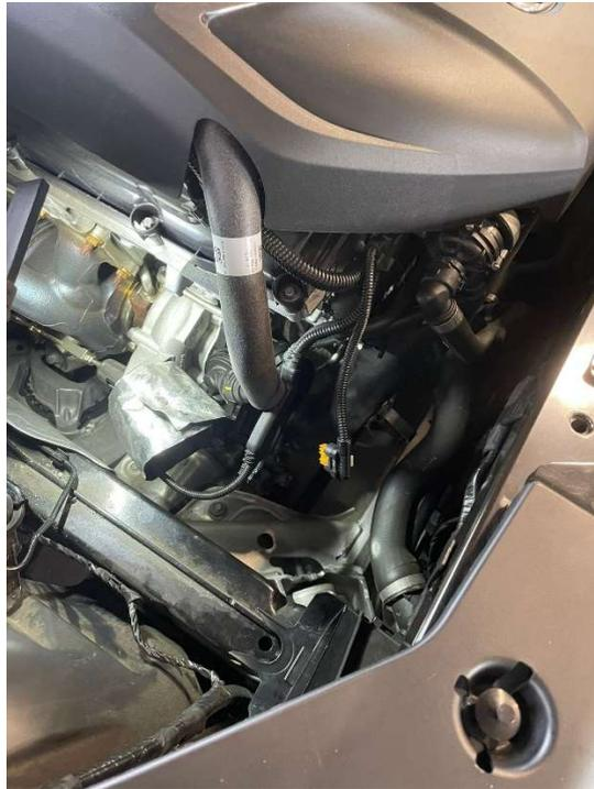
6. Als nächstes müssen die beiden Steckverbinder gelöst werden, um die Abdeckung umklappen zu können.
