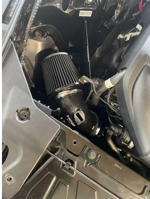
11. Zum Schluss muss der Luftmassenmesser am originalen Luftfilter demontiert, am Aluminium Rohr wieder montiert und angeschlossen werden.
