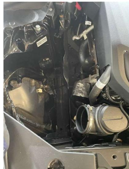
3. Lösen Sie nun den Stecker der Unterdruckleitung am Turboinlet.
