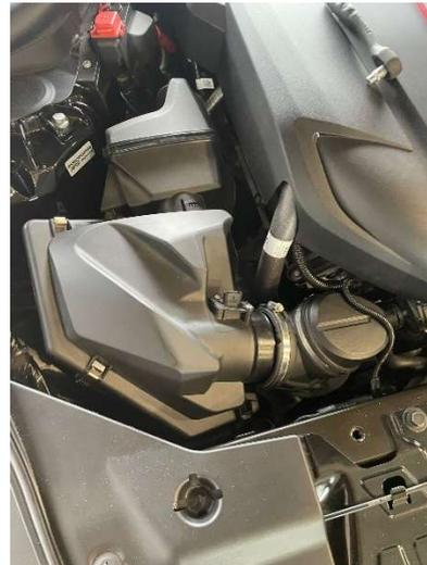
2. Nun lösen Sie erst die Schlauchschelle am Luftfilterkasten und ziehen dann den Luftfilterkasten nach oben raus.
