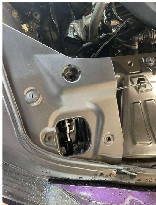
7. Als nächstes muss die im Bild gezeigte Schraube entfernt werden.
